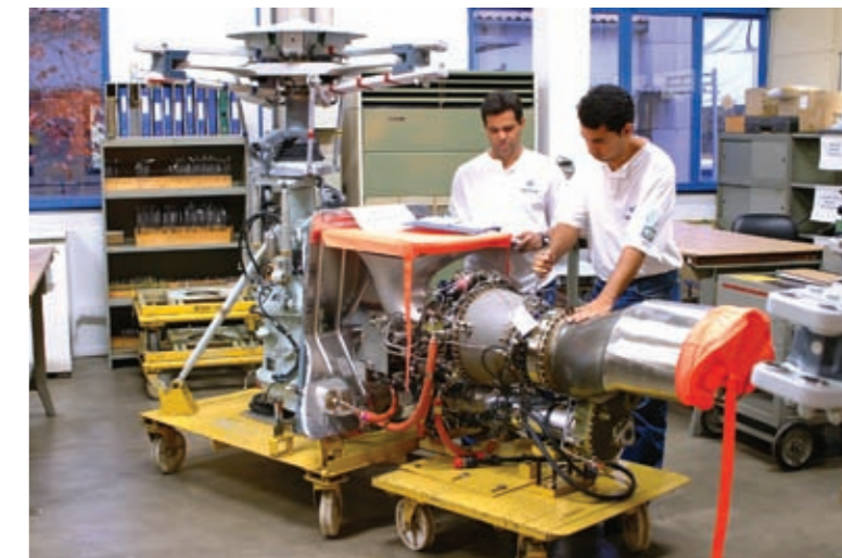
No detalhe, a turbina removida do helicóptero acima.
